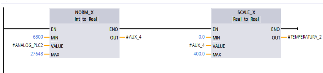
Figura 4.25. Escalamiento de la señal analógica.
