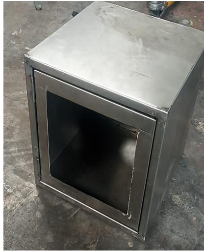
Figura 4.2. Estructura metálica del horno de temperatura.
