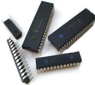
**Figura 3. 16.** Microcontrolador PIC
