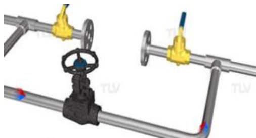
Figura Ñ.6. Instalación Baipás [3]
