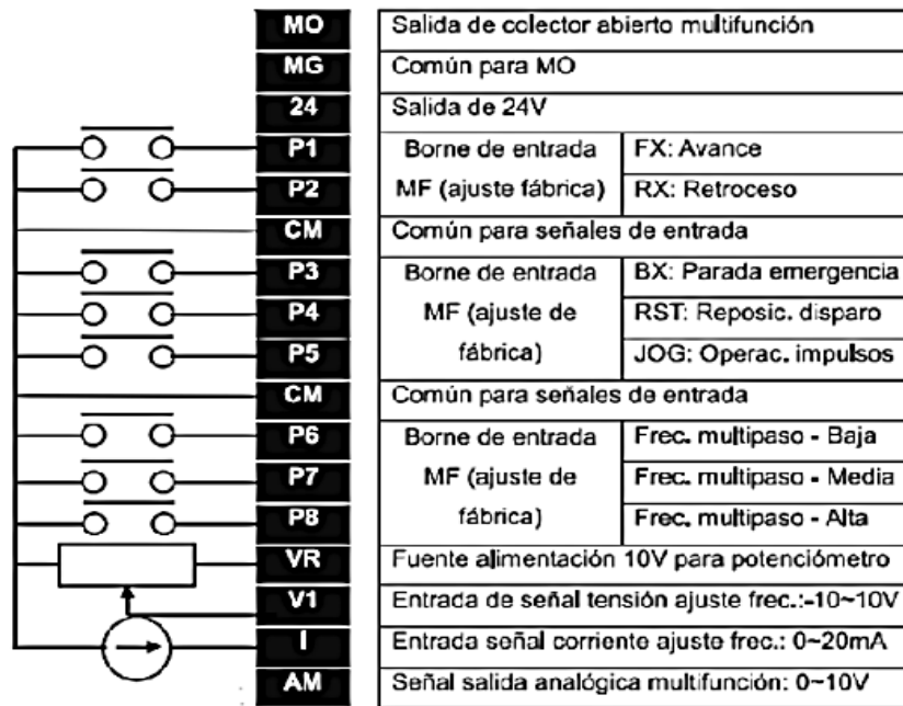
Figura 4.4 Conexiones de los bornes de entrada/salida
