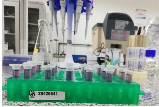
Fotografía 5. Cuantificación del contenido de proteína por métodos colorimétricos. Método Bradford.
