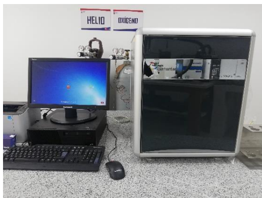
Fotografía 3. Cuantificación del contenido de proteína en harina de grillo por el método Dumas.
