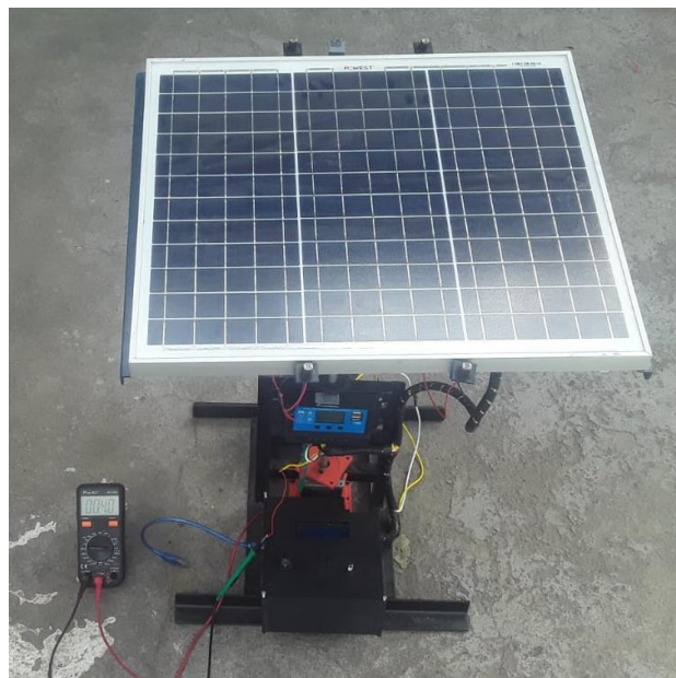
Figura 5.1. Estructura terminada del seguidor
