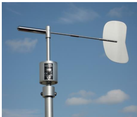
Figura 3.20. Conjunto de anemómetro de hélice y veleta [29].
