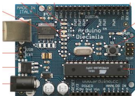
Figura 3.23. Descripción de componentes de la placa Arduino [35].
