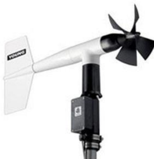
Figura 3.19. Conjunto de anemómetro de hélice y veleta [29].
