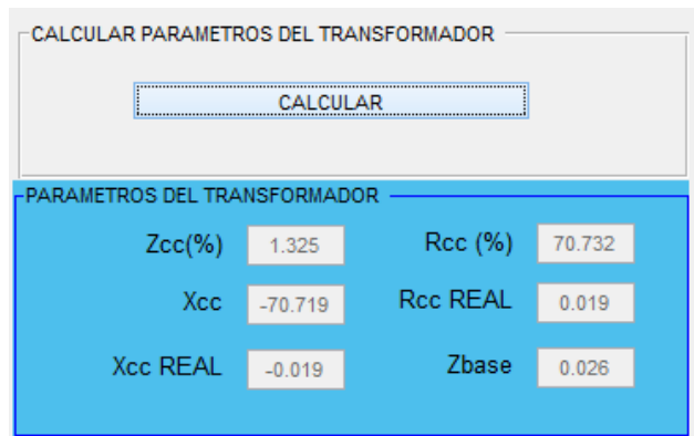
Figura 5.16. Resultados de los parámetros eléctricos del ensayo de cortocircuito en la venta de GUIDE.
