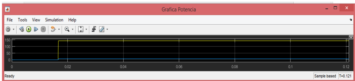
Figura 5.14. Onda de la potencia del ensayo de cortocircuito en el transformador monofásico.
