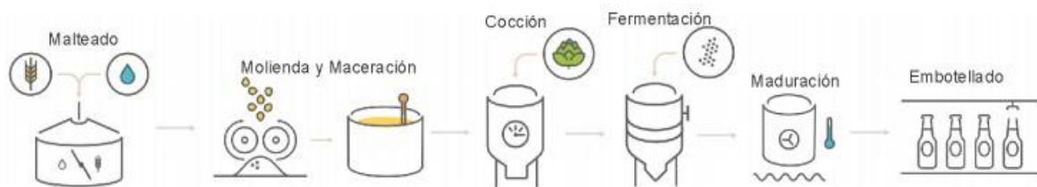
Figura 3.1. Diagrama del proceso de producción de cerveza. [8].
