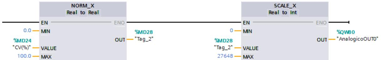
**Figura 4.16.** Normalizado y escalamiento de la señal analógica de salida
