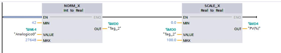
**Figura VI.26.** Primer segmento acondicionamiento variable PV
