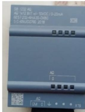
**Figura V.5.** Modulo SB 1232 va incrustado en el PLC S7-1200
