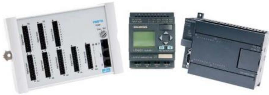
**Figura 3.8.** Ejemplos de PLC compactos [5]
