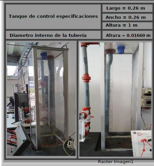
**Figura V.53.** Especificaciones tanque de control y tubería
