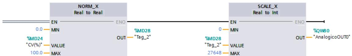
**Figura V.28.** Tercer segmento acondicionamiento variable CV
