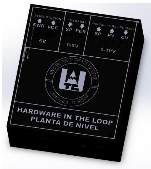
**Figura 4.10.** Diseño 3D de contenedor de planta
