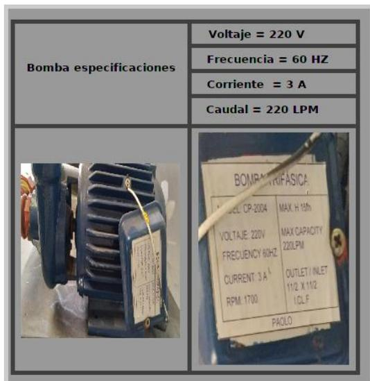
**Figura V.54.** Especificaciones Bomba de agua
