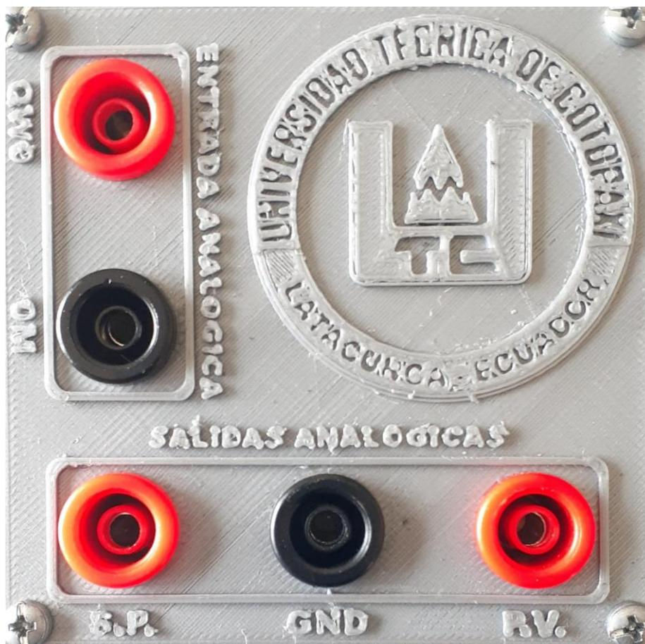
Este módulo de comunicación está diseñado para comunicar el entorno virtual de control de presión generado en Unity con el PLC S7-1200 de Siemens, consta de una entrada analógica (CV) que controla el actuador del entorno virtual de control presión de aire comprimido, dos salidas analógicas que ingresan al
