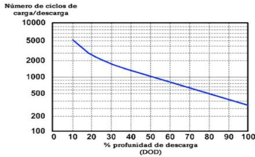
**Figura 3.11.** Representación de profundidad de descarga y ciclos
