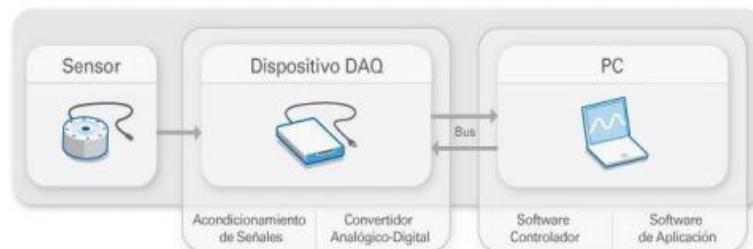
Figura 3.4. Partes de un sistema DAQ
