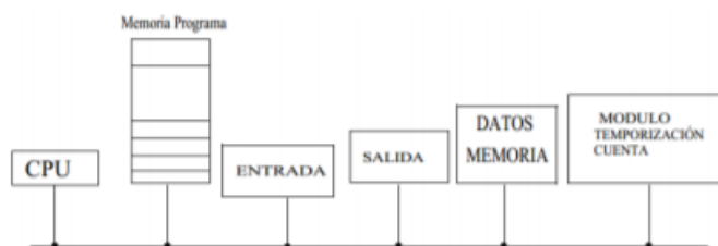
Figura 3.5. Diagrama de bloques de un PLC
