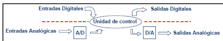
Figura 3.7. Sistema de control
