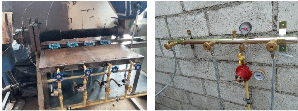
Figura 5.4 a) Sistema actual para la fundición del plástico; b) centralina
