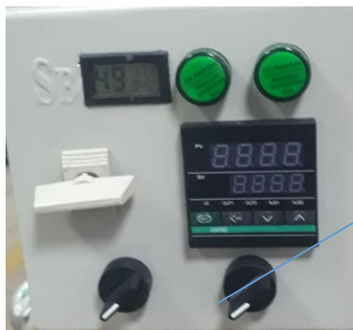
Fig1. Selector encendido de la máquina, del pirómetro y el sistema automático del quemador.
