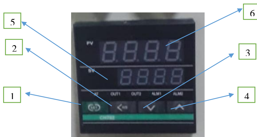
Fig4. Configuración del pirómetro para la temperatura.
