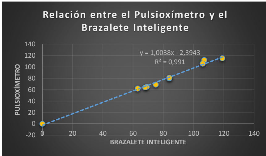
Figura XII.1. Exactitud entre Pulse Oximeter y el Brazaletes Inteligente
