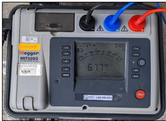
Figura 1. Megger en funcionamiento conectado al transformador Pau Mounted.
