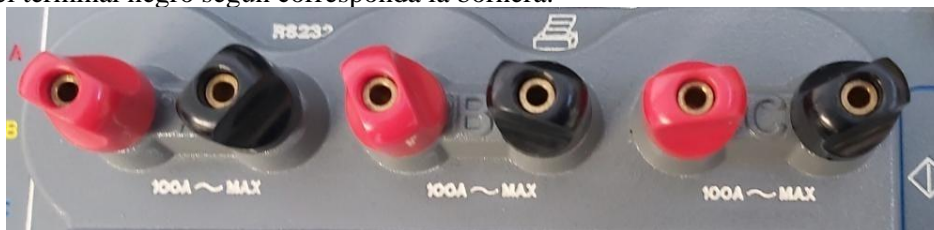
Figura 12. Entradas de las fases de corriente al PMM-1.
