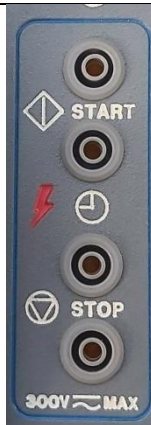
Figura 10. Bornes de conexión de los terminales del PMM-1.
