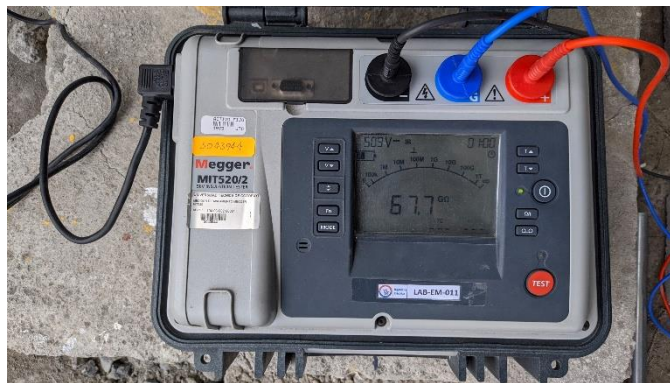
Figura 14. Conexión del Megger MIT 520/2.
