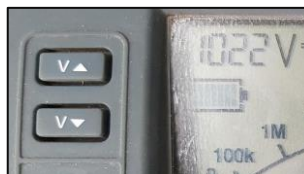
Figura 4. Botones de control de voltaje.
