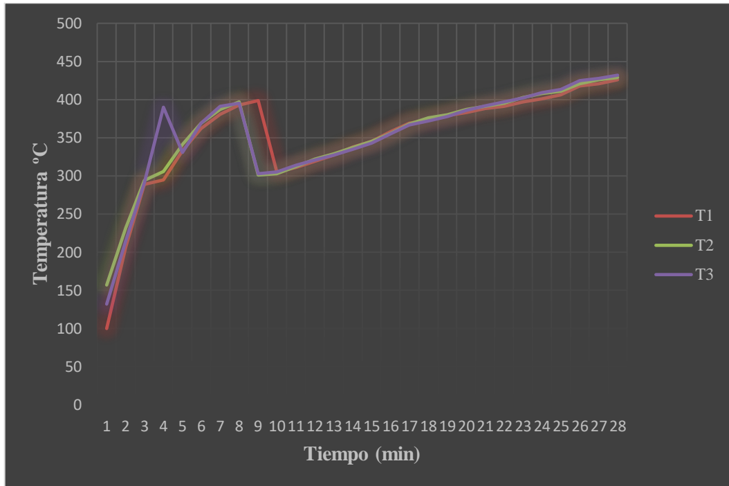
Figura 17. Temperatura vs tiempo fundición Zn (arranque caliente). Elaborado por: Investigador
