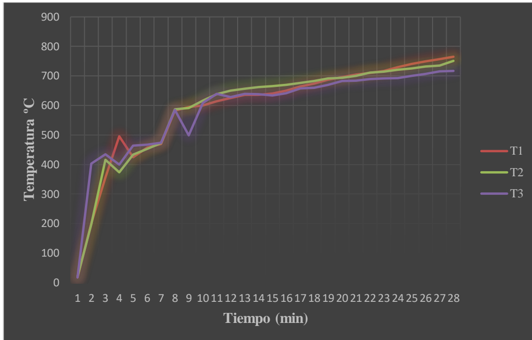
Figura 11. Temperatura vs tiempo fundición Al (arranque frío). Elaborado por: Investigador
