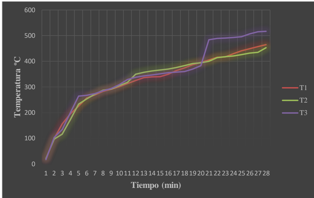
Figura 15. Temperatura vs tiempo fundición Zn (arranque frío). Elaborado por: Investigador
