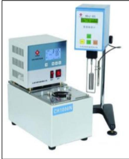
**Figura 2. 8 Viscosímetro Rotacional**
