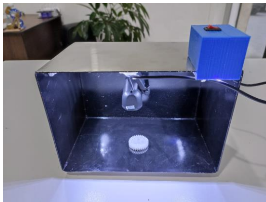
Figura 3.2. Caja metálica de visión artificial. Elaborado por: Mayo, Edison
