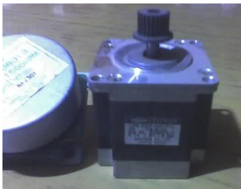
Figura 3.18. Motor a pasos del mecanismo de fotocopiado. Elaborado por: Mayo, Edison
