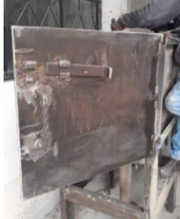
Figura 2.15 Cubierta metálica como puerta del horno N. 2
