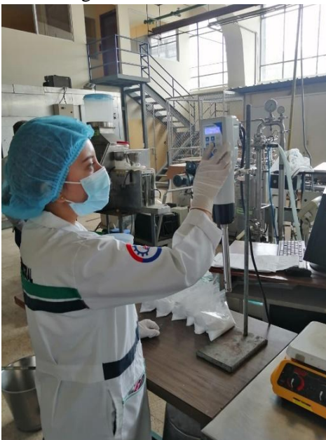
Fotografía 15: Calibración del homogeneizador
