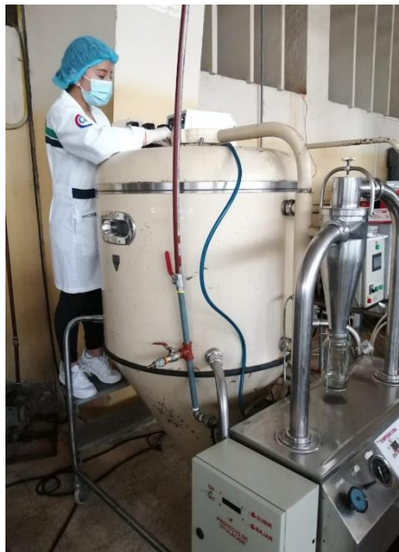
Fotografía 18 & 19: Secado por aspersión (equipo pray dryer)
