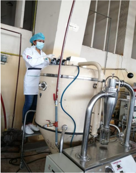
Fotografía 18 & 19: Secado por aspersión (equipo pray dryer)
