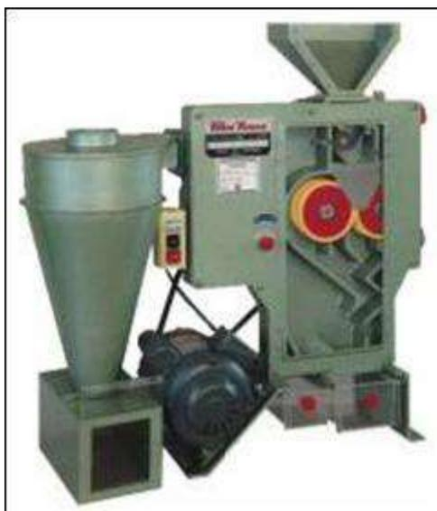
**Figura 1** Descascarilladora de Cacao
