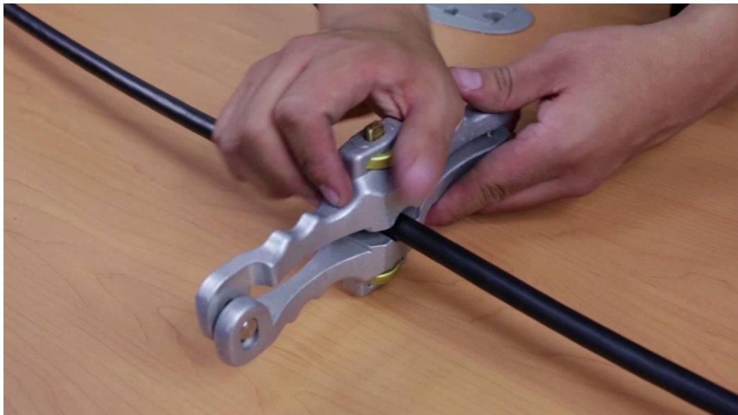
Gráfico 48. Sangrado de cables FO para empalmes.
