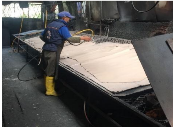
Figura 29. Acabados (pintado del cuero a soplete).
