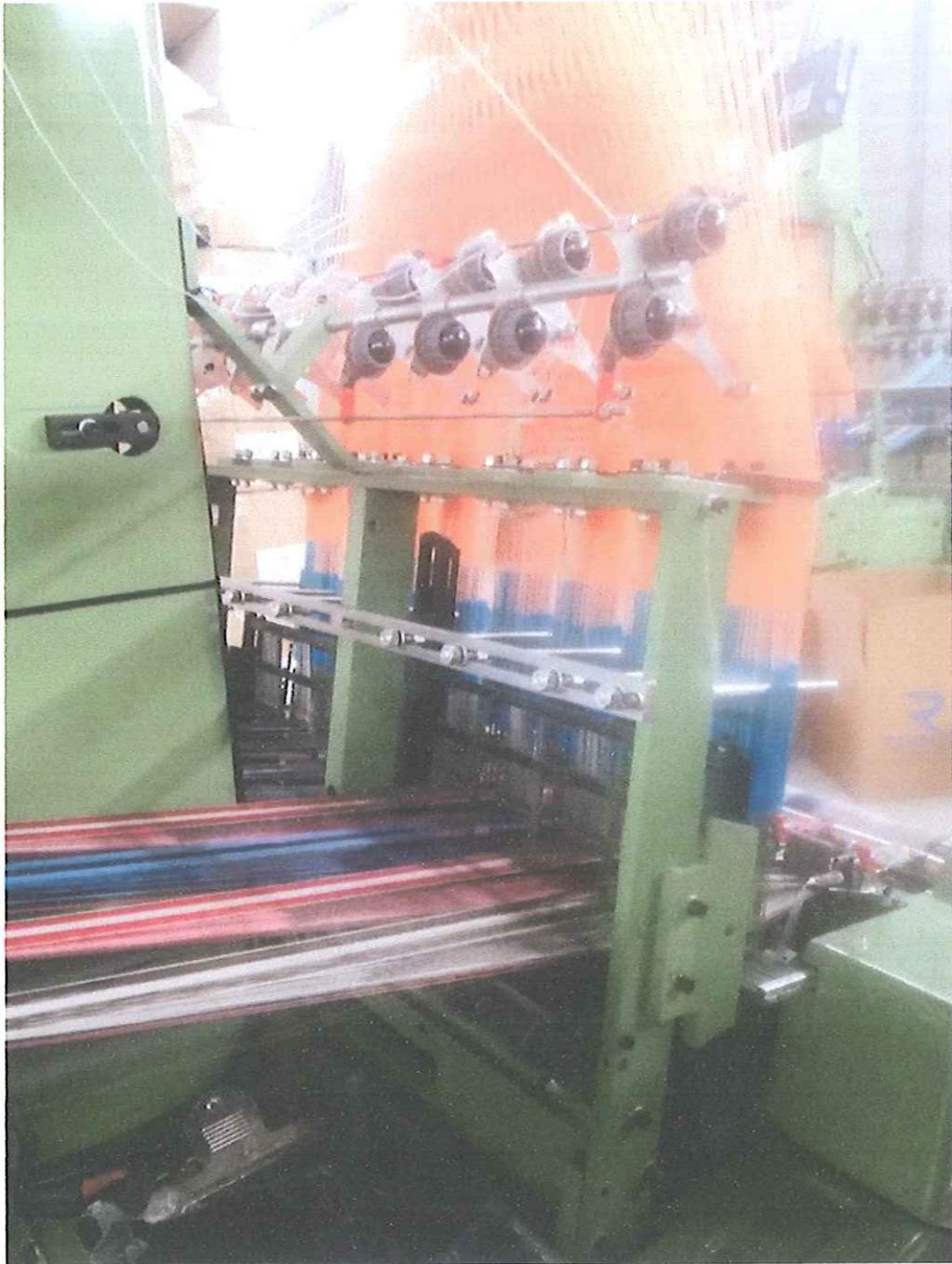
**Figura 5.5.** Hilos urdidos colocados en la máquina teladora.
