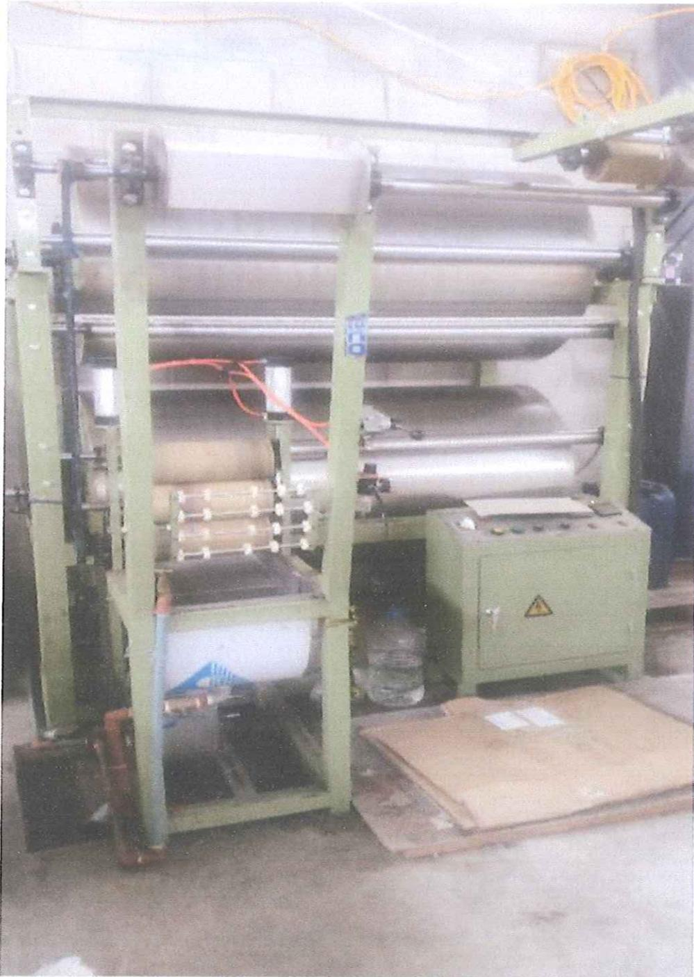
Figura 5.6. Planchadora Industrial para cintas elásticas.
