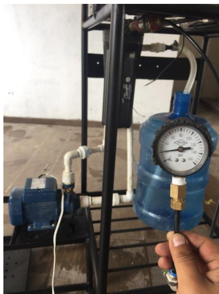
Ilustración 33: Presión de salida total de la bomba de lavado
