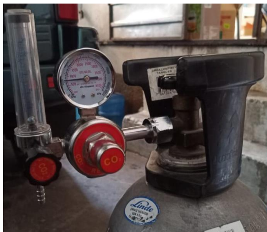
Ilustración 34: Presión del tanque de CO 2 utilizado en la máquina.
