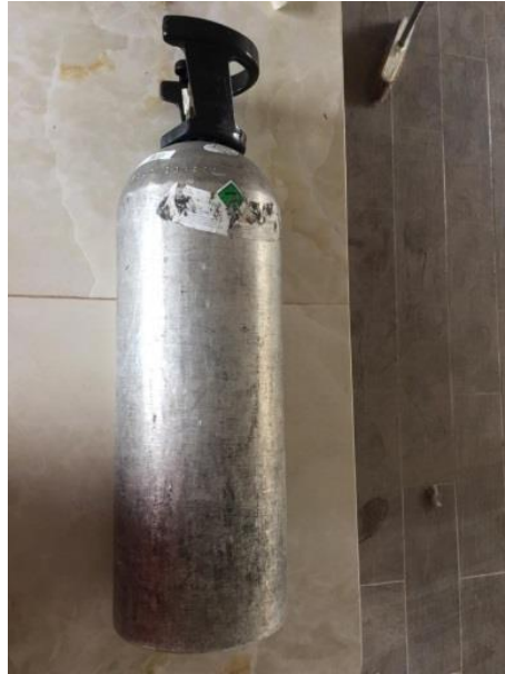
Ilustración 59: Tanque de CO2.
