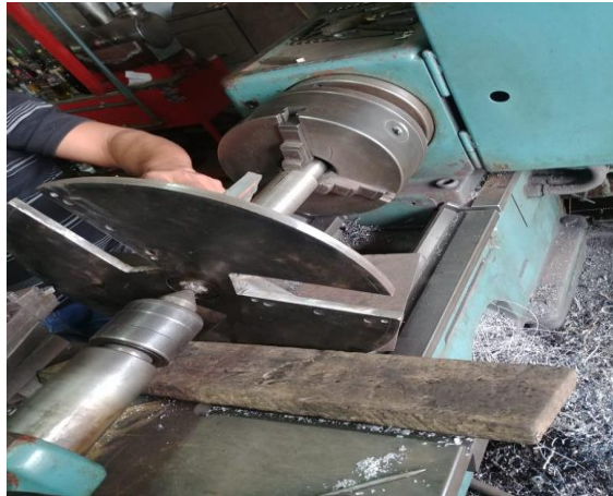
Figura 8.18 Mecanizado de volante de inercia
