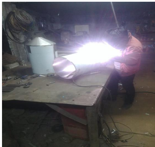
Figura 8.19 Proceso de soldado de silos
