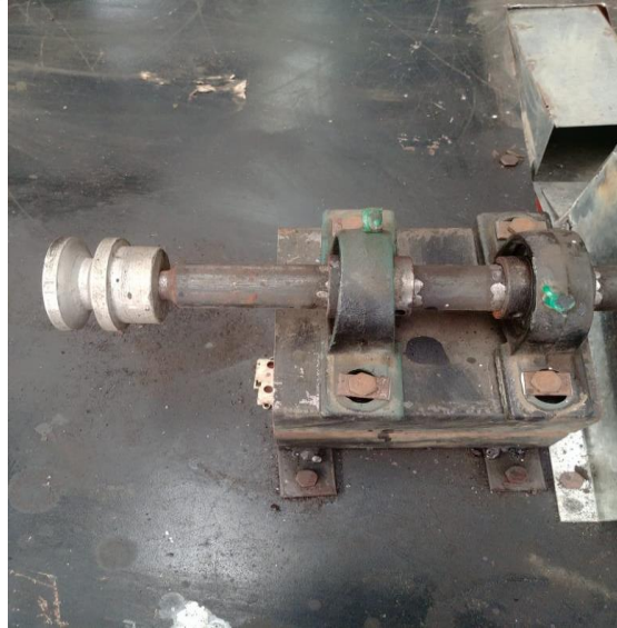
Figura 8.17 Eje acopladas a chumaceras y polea
