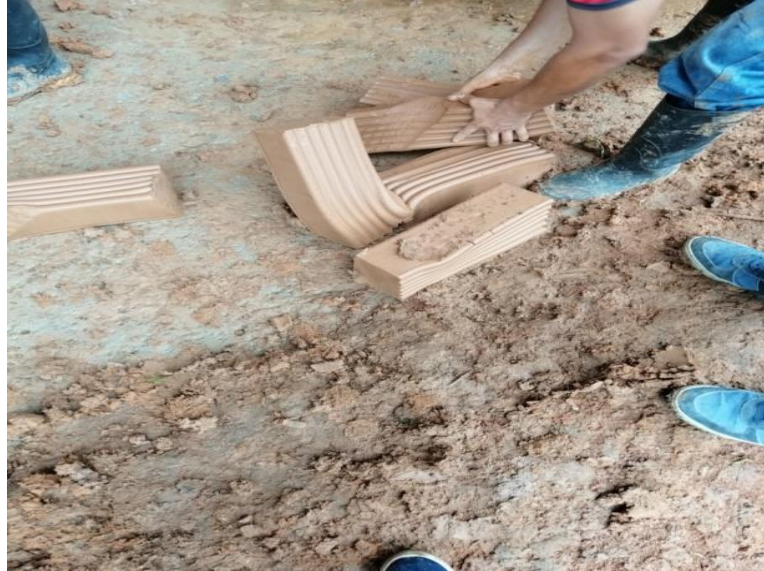
Gráfico 28. Producto mal dimensionado de Ladrillera de Lago.
