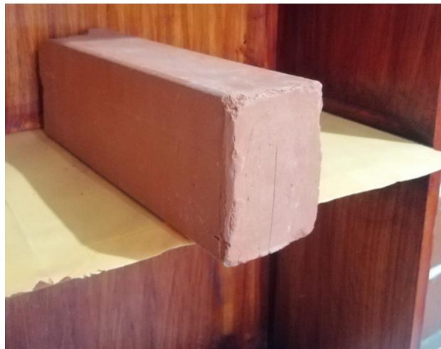
Gráfico 29. Ladrillo con defecto de compactación.
