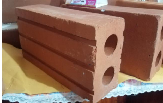
Gráfico 30. Ladrillos con defectos en el Labrado.
