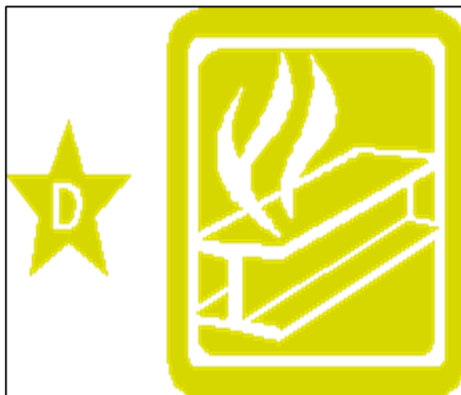
Figura N°12. Incendio Clase D.
