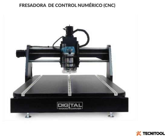
*Gráfico 3 máquina fresadora de control numérico CNC de 3 ejes*
