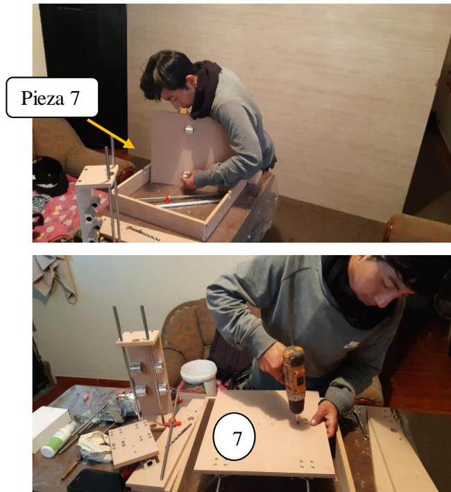
**Imagen 2** Ensamble de la pieza 7 base del eje “Y” de la máquina CNC.
