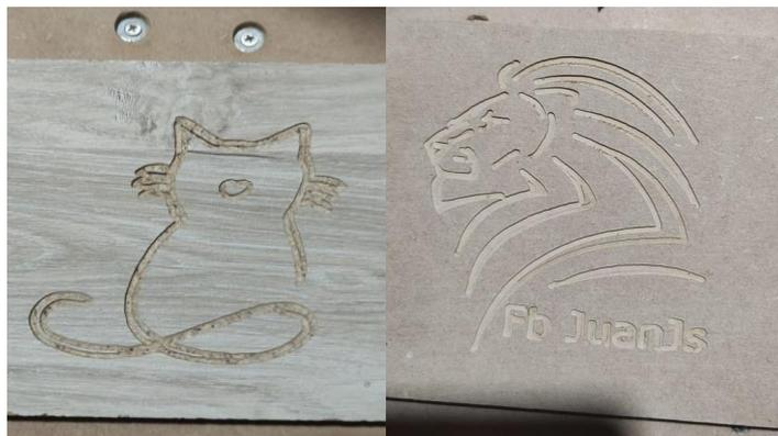
***Imagen 15** Dibujos tallados a través del prototipo de la máquina CNC.*
