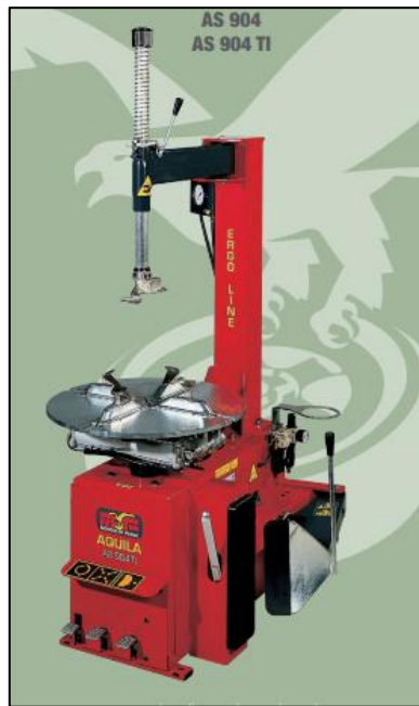
Figura 3. 1 Desenllantadora Mondolfo Ferro modelo AS904.
