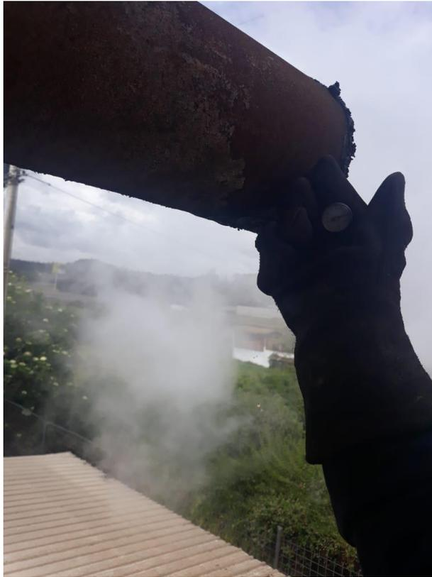
**Figura 10.9.** Toma de muestras de la temperatura de los gases del digestor.
