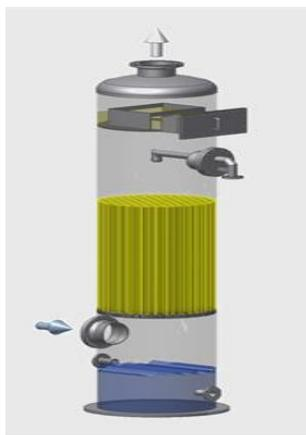
**Figura 3.8.** Lavador de gas tipo torre empacada.
