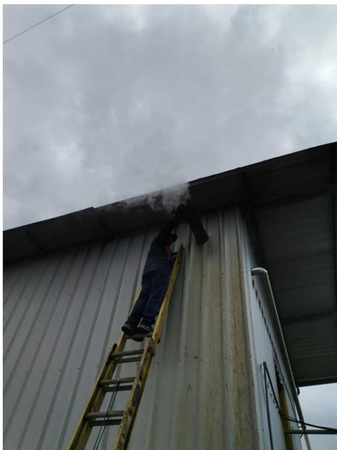
**Figura 10.8.** Toma de muestras de la temperatura de los gases del digestor.
