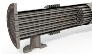
La Serie HRS K es un intercambiador de calor de tubo y camisa en acero inoxidable, diseñado para uso industrial. El producto fluye a través de los tubos interiores y el fluido de servicio fluye a través de la camisa.
