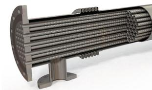
La Serie HRS K es un intercambiador de calor de tubo y camisa en acero inoxidable, diseñado para uso industrial. El producto fluye a través de los tubos interiores y el fluido de servicio fluye a través de la camisa.
