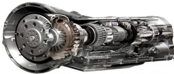
**Figura 3. 5.** Caja de cambios del automóvil.
