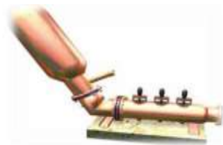
Figura 3.9 Ariete Multipulsor Fuente: [11]
