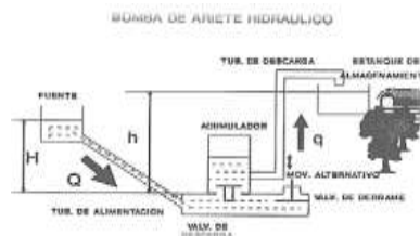
Figura 3.8 Ariete monopulsor Fuente: [11]
