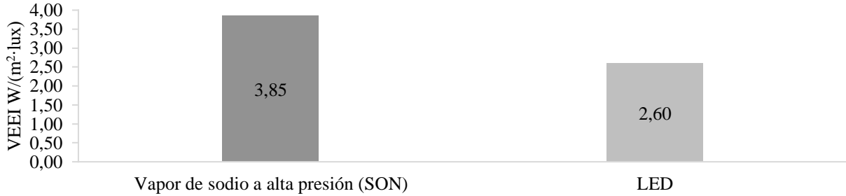
Fig. 62. Eficiencia energética de la iluminación LED y SON en el patio de espera.
