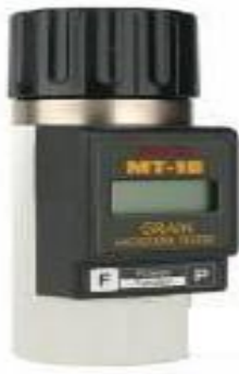
Foto 31. -Instrumento para tomar la humedad del grano
