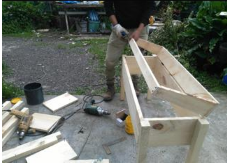
Grafico 27: Ensamblaje de la bandeja de bioresiduos al cuerpo del bioreciclador.
