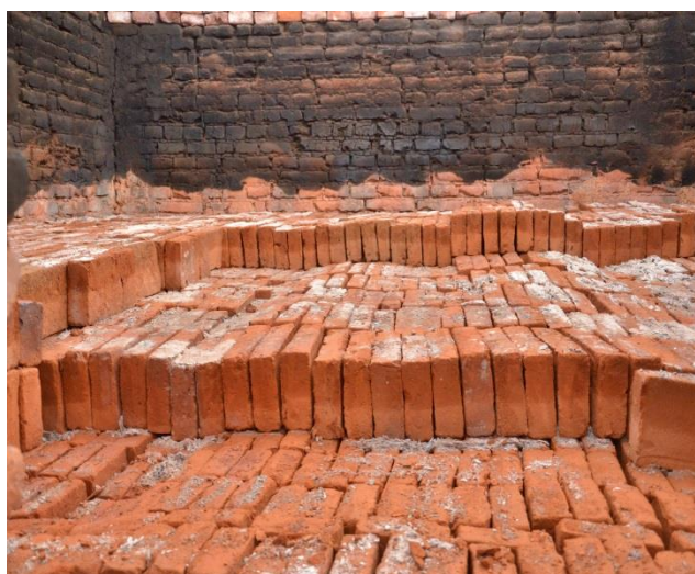
Fotografía 2.- Carga de ladrillos en el horno
