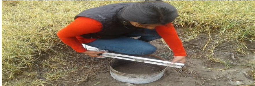
Gráfico 8: Instalación de las anillas
