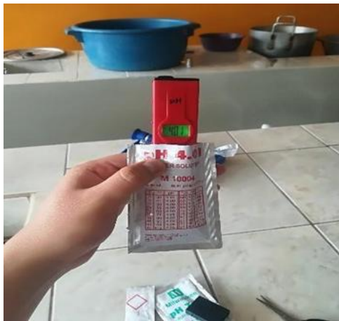
Fotografía 21: Calibración del pH metro
