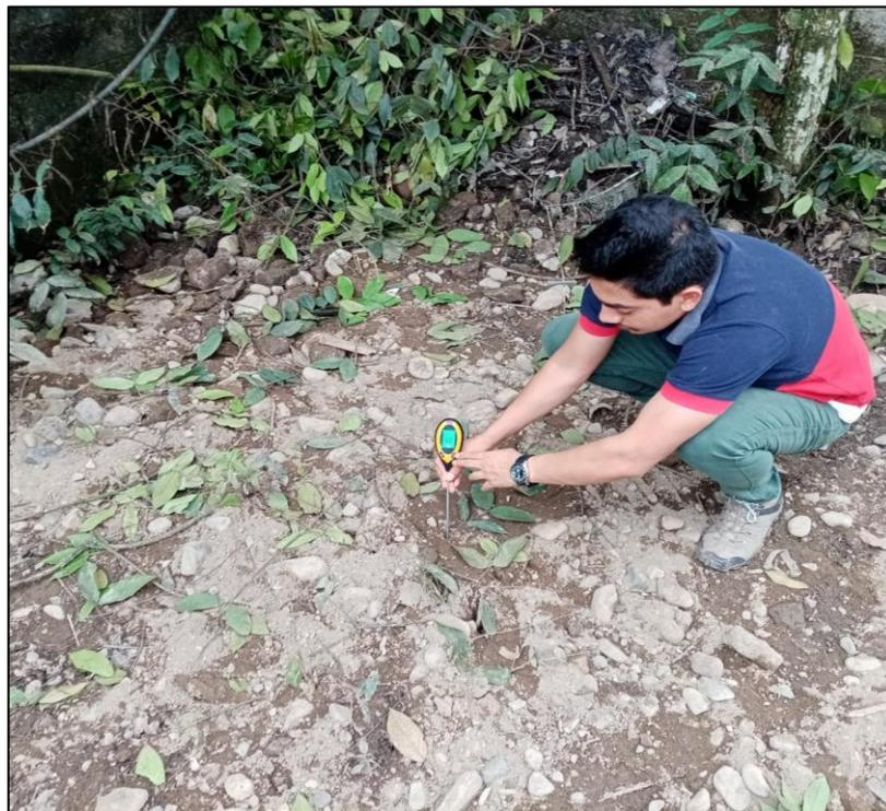
**Descripción:** Mediante el dispositivo de medición de variables ambientales del suelo, se recolecta información de alta relevancia para que esta sea analizada y procesada para su aplicación y empaquetamiento de los modelos de inteligencia artificial que serán implementados en el aplicativo web.
