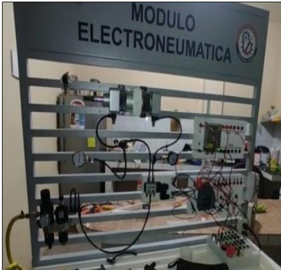
Imagen 19: Práctica # 2 realizada en el módulo didáctico de electro-neumática
