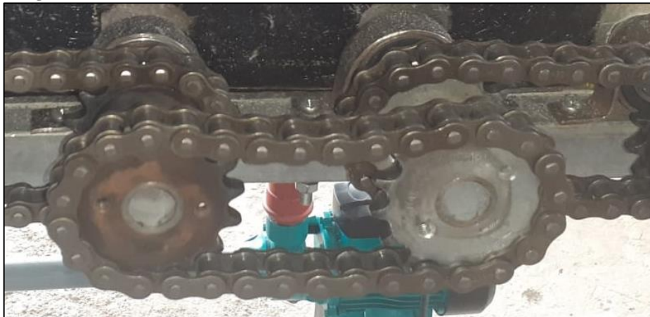
Imagen 14: cadenas de transmisión de rodillos
