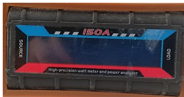
Figura 48. Power analizar C.C
