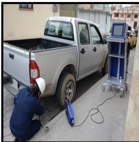
Colocación del opacímetro en el tubo de escape
