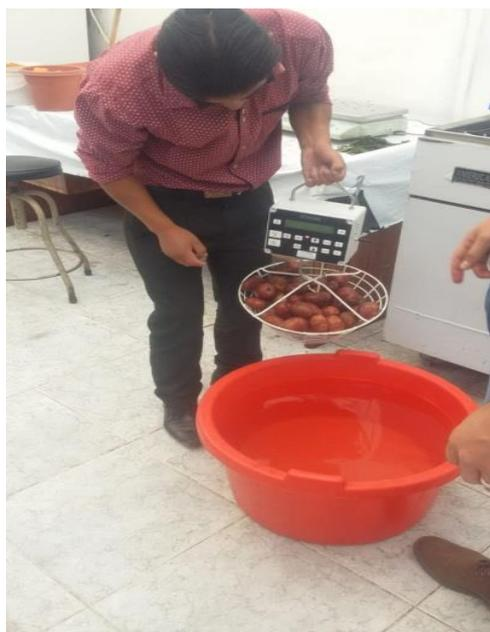
Fotografía 13. Método del hidrómetro para cálculo de materia seca
