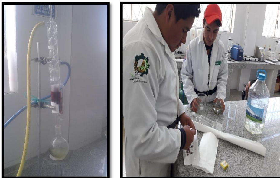
Fotografía 10: Extracción del colorante con el equipo soxhlet.
