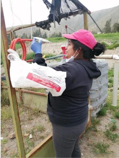
**Ilustración 2:** Esterilización de bolsa Tedlar con biogás
