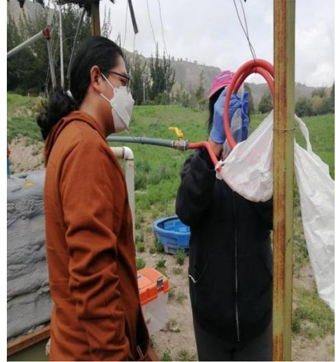
**Ilustración 3:** Toma de muestra de biogás
