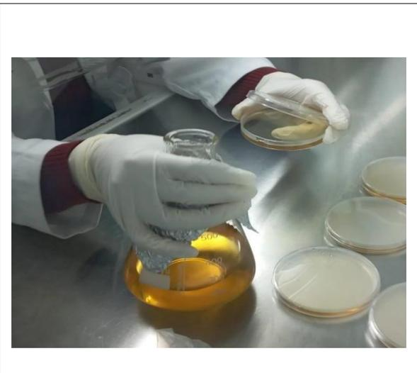
Ilustración 19: Dilución de la muestra de agua
