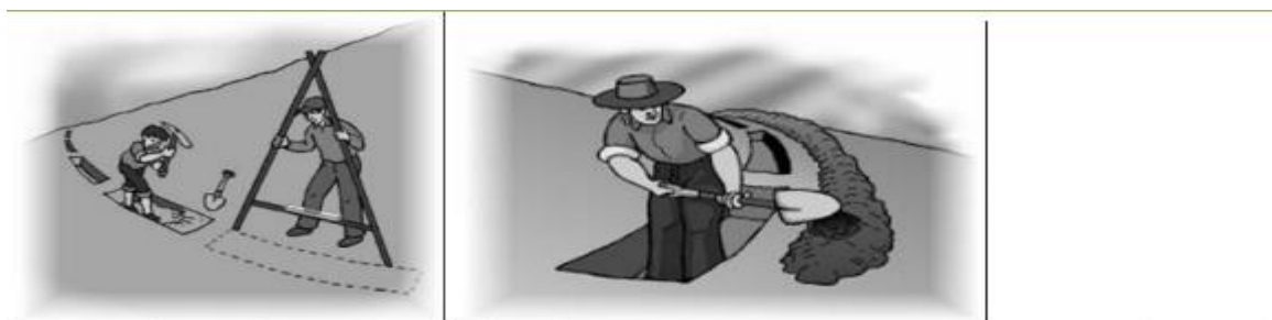
Trazando la línea sin caída para la zanja de infiltración. Depositando la tierra en la parte baja de la zanja. (figuras: INIA)
